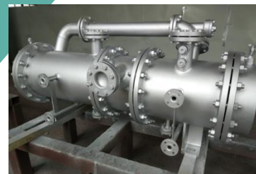
Устройства сопряжения: парогенераторы и устройства подготовки рабочего тела (эжекторы, скруббер) и др.
